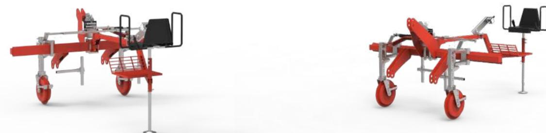
4. **Hydraulisch verschiebbarer Rahmen, feste Räder, Joystick-Steuerung und Sitz für den Bediener.**
